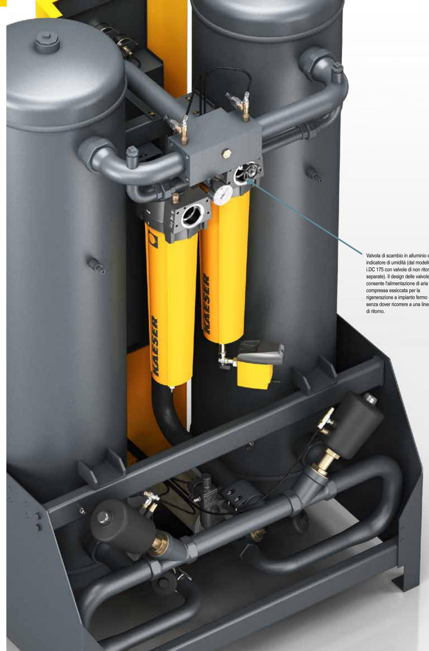
Valvola di scambio in alluminio e indicatore di umidità (dal modello i.DC 175 con valvole di non ritorno separate). Il design delle valvole consente l'alimentazione di aria compressa essiccata per la rigenerazione a impianto fermo - senza dover ricorrere a una linea di ritorno.
