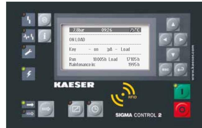
L'unità di controllo interno SIGMA CONTROL 2 coordina la produzione e il consumo di aria compressa. Il sistema di gestione e controllo intelligente consente di evitare sprechi di energia, soprattutto con carichi parziali. KAESER offre diverse modalità di controllo a seconda del fabbisogno.
